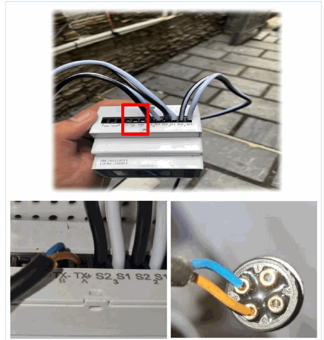
Hình 1.4b — Ảnh thực tế: vị trí chân đấu trên meter và đầu nối RS485 male/female.
