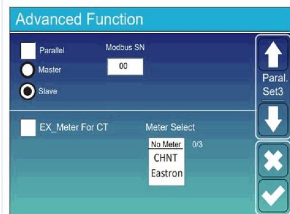
Hình 4.3b — Advanced Function: Parallel / Master / Slave, Modbus SN 00, EX_Meter For CT với Meter Select (No Meter, CHNT, Eastron) và phần giải thích tiếng Anh “Ex_Meter For CT: when using zero-export to CT mode, the hybrid inverter can select EX_Meter For CT function and use the different meters.e.g.CHNT and Eastron.”
