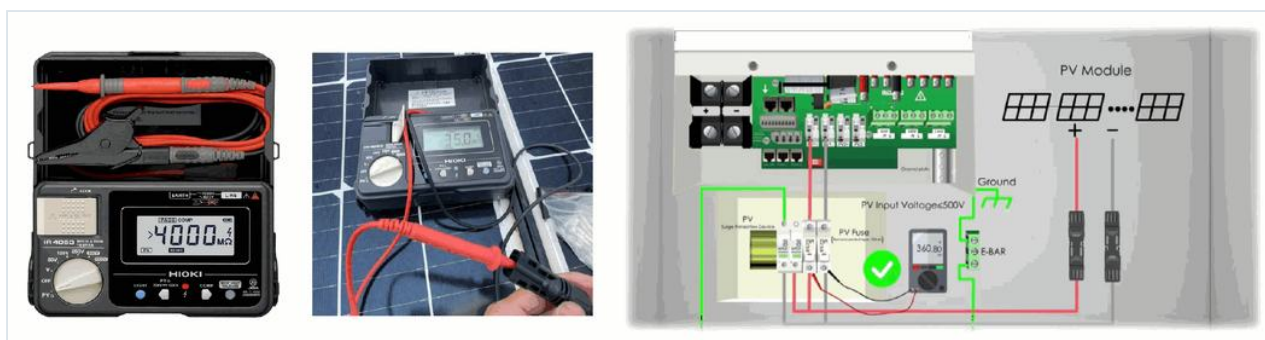
Hình 3.1 — Đồng hồ đo điện trở cách điện PV HIOKI IR4053-10 và vị trí đo trên hộp đấu nối PV (PV Input Voltage < 500V).
