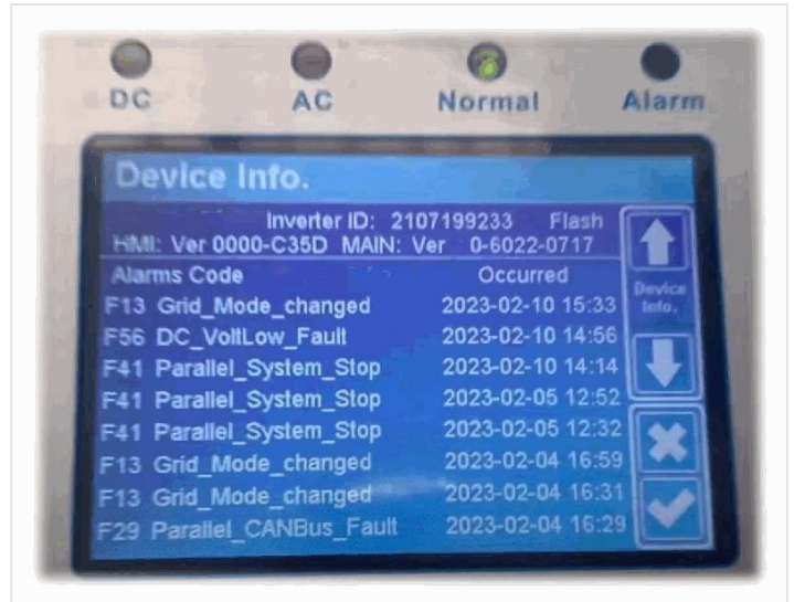
Hình 5.6 — Device Info.: Inverter ID 2107199233, HMI: Ver 0000-C35D, MAIN: Ver 0-6022-0717 và danh sách Alarms Code (F13, F56, F41, F29) kèm thời điểm xảy ra.
